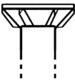
Der Flachsenkopf mit Fräsrippen entspricht nahezu dem herkömmlichen Flachsenkopf und kommt fast ausschließlich bei Holzbau- oder Spanplattenschrauben, selten auch bei Schnellbauschrauben zum Einsatz. Die sich direkt am Kopf befindlichen Fräsrippen zerteilen beim Einschrauben und Versenken die Holzfasern direkt unter dem Kopf und vermindern somit erheblich das Risiko von Rissbildung oder Spaltung des Materials.
